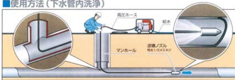
高圧ホースの先に取り付けた逆噴ノズルから後方にジェット水流を噴射し、管内の汚泥を攪拌しながら前進します。次にホースリールに巻き戻すことによりマンホール方向にジェット水流が汚泥を洗い流し、スピーディーに管内洗淨ができ、マンホールなどの通常のガン洗淨もコックの切り換えで簡単におこなえます。
